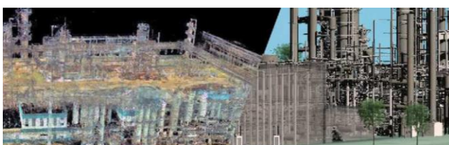
- 3D-модель завода, созданная по результатам наземного сканирования
